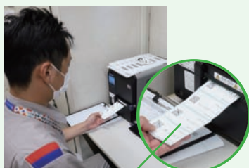
RFIDタグの印刷 RFIDタグラベル → 製品に貼り付け
