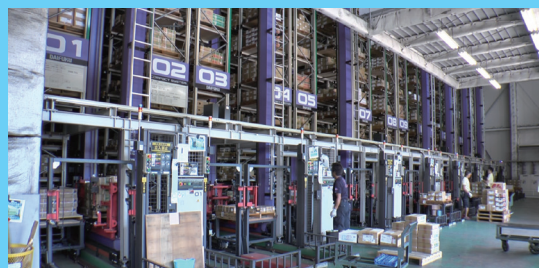
パレットの積荷を自動で振り分ける超高速クレーン
