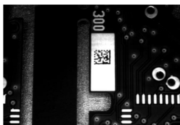
図 16 - インクジェットプリンタを使用してプリント基板銅箔にダイレクトマーキングされたドットマトリクスコード
