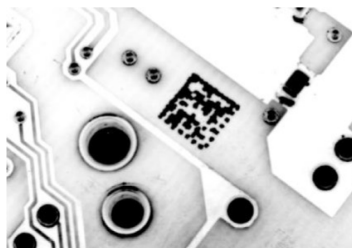
図 17 - レーザエッチングテクノロジーを使用してプリント基板表面にダイレクトマーキングされたデータマトリクスコード
