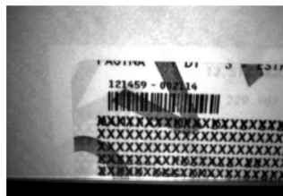
図 11 - Matrix 220 によって封筒の窓フィルム越しからでも読み取り可能なオーバープリントされたバーコード
