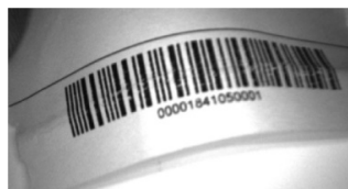
図 12 - 画像の光学的歪みがあってもMatrix 300N によって読み取り可能な曲面に印刷されたバーコード
