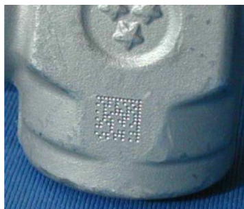
図 13 - ドットピーニングテクノロジーを使用して金属表面にダイレクトマーキングされたドットマトリクスコード
