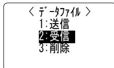
⑧ ファイルの格納先を選択します。格納先を選択して、**ENT** キーを押すと、HLT-700-02 が受信待ちの状態になります。ホストコンピュータの「Welfer II for Windows」で、前ページ④画面の [開始] ボタンを押すと、HLT-700-02 はファイルの受信を開始します。
