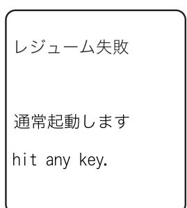
■キーを押さずにバッテリーを取り外して電源 OFF した後の起動では、レジュームに失敗します。
