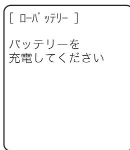
約5秒後に強制的に電源をOFFにします。
