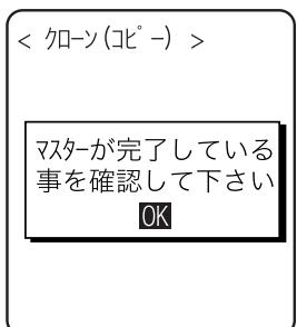
コピー端末側ではクローンが完了したことを確認できませんので、必ずマスター端末側の画面で転送が完了していることを確認してください。もしマスター端末側の転送が完了していない場合は、再度クローンを行なってください。
