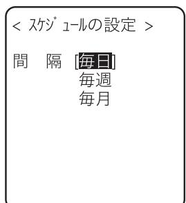
毎日(時刻指定)、毎週(曜日と時刻指定)、毎月(日にちと時刻指定)から選択できます。日にちは『01』～『31』で、時間は 24 時間形式で設定します。設定が完了するとスケジュールの確認へ戻ります。
