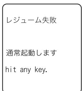
⑩キーを押さずにバッテリーを取り外して電源 OFF した後の起動では、レジュームに失敗します。
