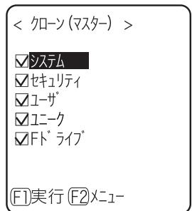
コピー端末がクローン可能な状態になっていることを確認したら、[F1]キーを押してクローンを開始します。
