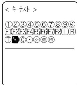
キーを押すと、画面中央の区切り線の上に表示されているアイコンが反転表示(ENTキーのみ逆)するほか、区切り線の下にはキーに対応したアイコンが表示(ローカルエコー)されます。
