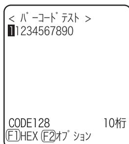
読取ったバーコード、バーコードの種類、桁数を表示します。
