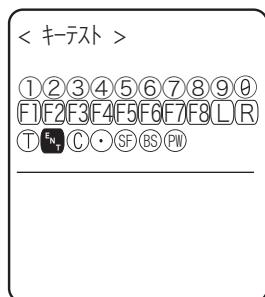
キーを押すと、画面中央の区切り線の上に表示されているアイコンが反転表示(回りキーのみ逆)するほか、区切り線の下にはキーに対応したアイコンが表示(ローカルエコー)されます。
