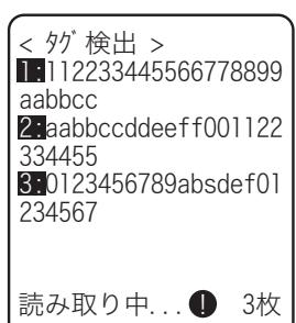
読み取りに成功すると、ICタグのEPCが表示されます。複数のICタグを同時に読み取った場合は、最大4枚まで画面上に表示し、同時に「ピッ」とブザー音が鳴ります。
