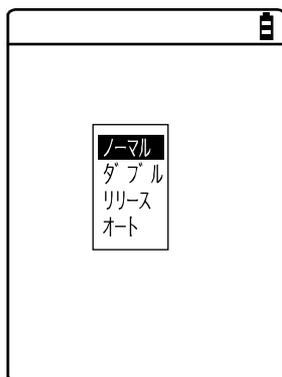
読取りキーの操作とレーザの照射パターンを設定します。バーコードはレーザが照射（点灯）されている状態で読取ることができます。
