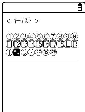
キーを押すと、画面中央の区切り線の上に表示されているアイコンが反転表示（【ENT】キーのみ逆）するほか、区切り線の下にはキーに対応したアイコンが表示（ローカルエコー）されます。
