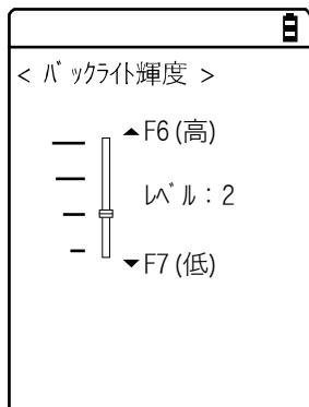
【▲】キーで上に、【▼】キーで下にスライダーを移動し、【ENT】キーで輝度を設定します。
