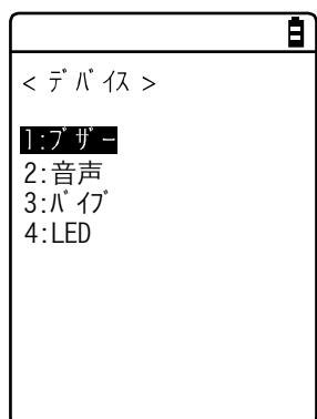
手順①の画面で、設定する項目を選択した後、【ENT】キーを押すとデバイス名が表示されます。
