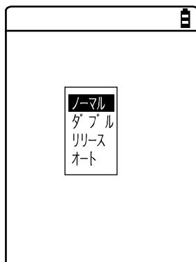
読み取りキーの操作とレーザの照射パターンを設定します。バーコードはレーザが照射（点灯）されている状態で読み取ることができます。
