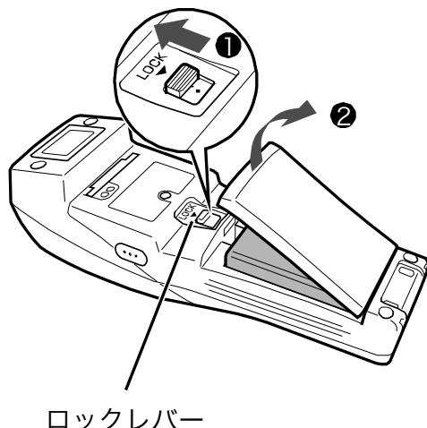
③バッテリーパックの後端（読み取り口側）を浮かせて取外します。
