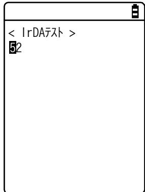
他の端末と赤外線通信ポート同士を向かいあわせに配置し、他の端末も赤外線通信テストを開始します。
