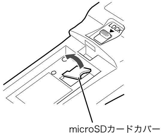
③microSD カードをスロットに差込みます。このとき、microSD カードの電極面を下にして、カードの矢印（▲）をスロット方向に向けます。
