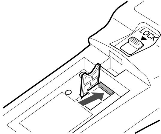
③ロックが外れて microSD カードが少し飛出してくるので、指でカードを引抜きます。
